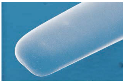
REM image atraumatic tip of a YASARGIL Clip from Aesculap; smooth surface prevents damage to tissue. REM-Aufnahme atraumatische Spitze eines YASARGIL Clip von Aesculap; glatte Oberflächen verhindern eine Verletzung des Gewebes.
