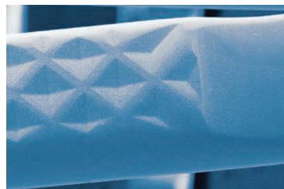
REM image atraumatic blade profile of a YASARGIL Clip from Aesculap; the deep, symmetrical, pyramidal stamping of both blades doubles the contact surface area and counteracts the slip effect. REM-Aufnahme atraumatisches Maulprofil eines YASARGIL Clip von Aesculap; die tiefen, symmetrischen, pyramidenförmigen Einprägungen in beiden Maulteilen verdoppeln die Auflagefläche und gewährleisten sicheren Halt.
